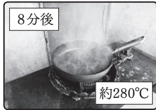
8分後 白煙が発生してきました。
