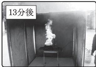
13分後 火柱は1 mを超えました！
